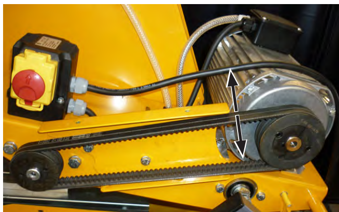
Проверка натяжения обоих клиновых ремней Рис. 4.24
