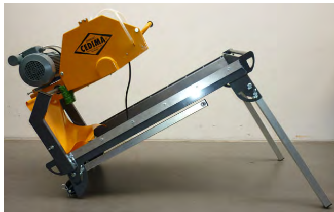
Пара опорных ножек вывернута (установка пилы) Рис. 4.9
