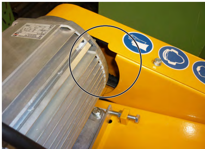
Место доступа для проверки обоих клиновых ремней на двигателе привода диска Рис. 4.23
