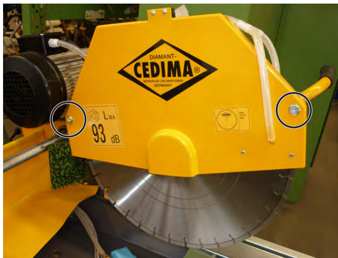
Закройте кожух диска и зафиксируйте круглыми гайками Рис. 4.33
