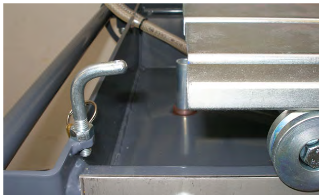
Фиксатор роликового стола смонтирован
