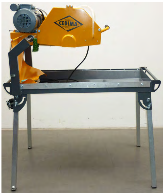
Вторая пара ножек вывернута (установка пилы) Рис. 4.12
