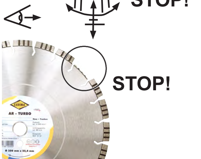
Замените дефектный, болтающийся, с отсутствующими сегментами и с некруговым вращением алмазный диск Рис. 4.34
