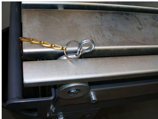
Транспортная фиксация роликового стола
