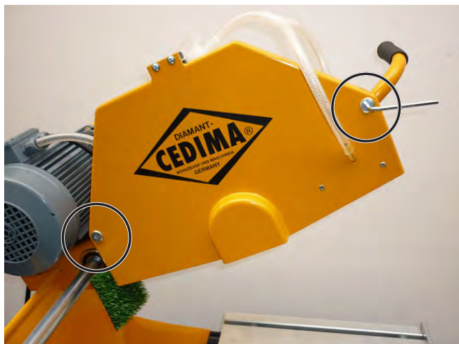
Отвинтите круглые гайки на кожухе диска
