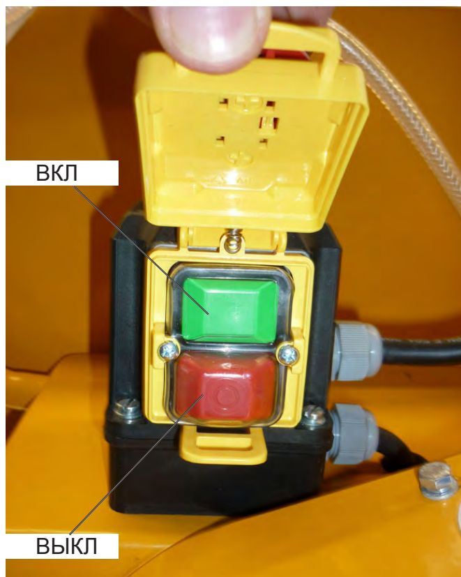
ВКЛ/ВЫКЛ, аварийн. выкл., клапан открыт
