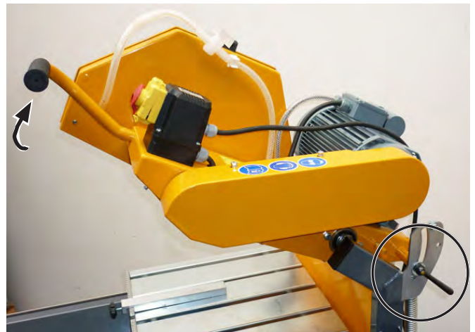
Поднимите режущий рукав и зафиксируйте зажимным рычагом
