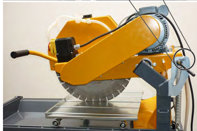
Установите ограничительный винт режущего рукава Рис. 4.37
