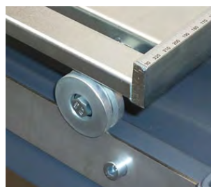
Установите роликовый стол с направляющими роликами на направляющие шины Рис. 4.17
