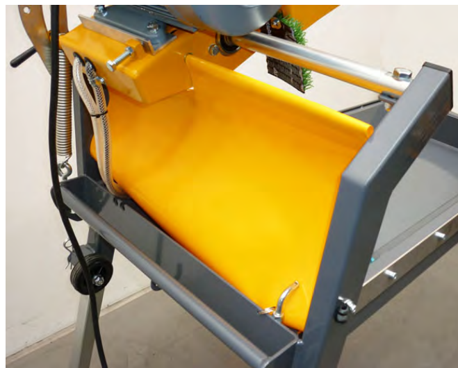
Заправьте защитный брызговик в водяную ванну Рис. 4.16
