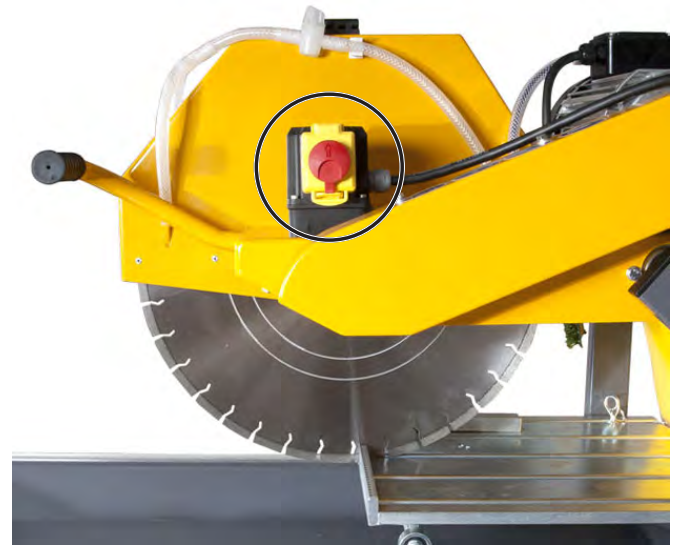
ВКЛ/ВЫКЛ, аварийный выключ., место на CTS•200 Рис. 4.41
