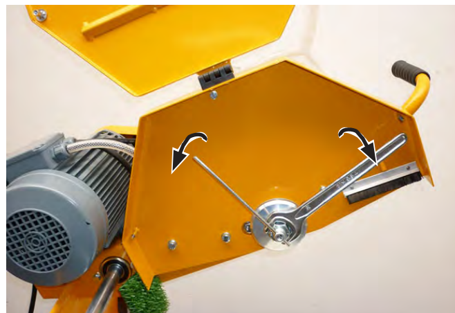
Отвинтите прижимную гайку с режущего вала
