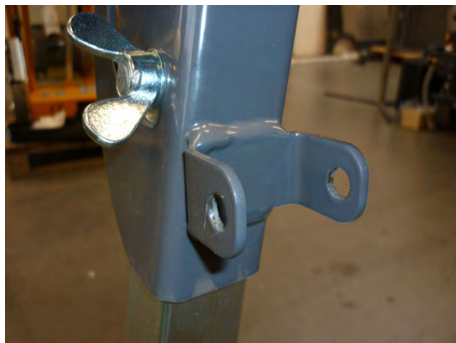
Крепление ролика на раме пилы
