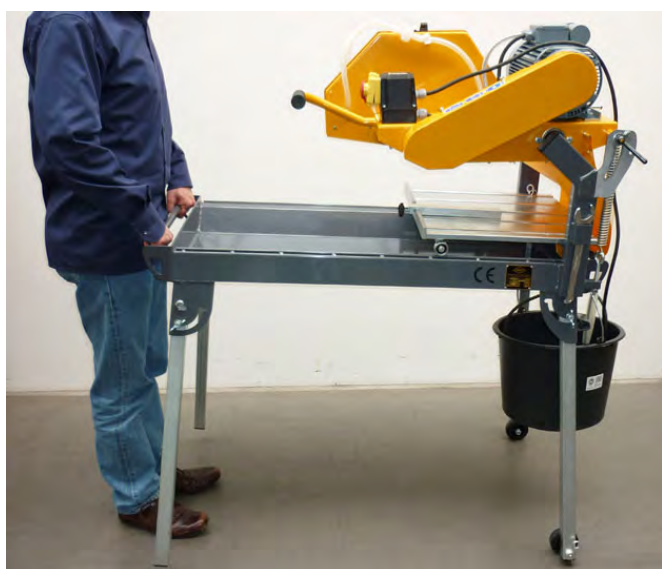
Транспортировка настольной пилы смонтированными на ножках роликами
