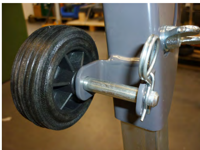
Ролик смонтирован на раме пилы
