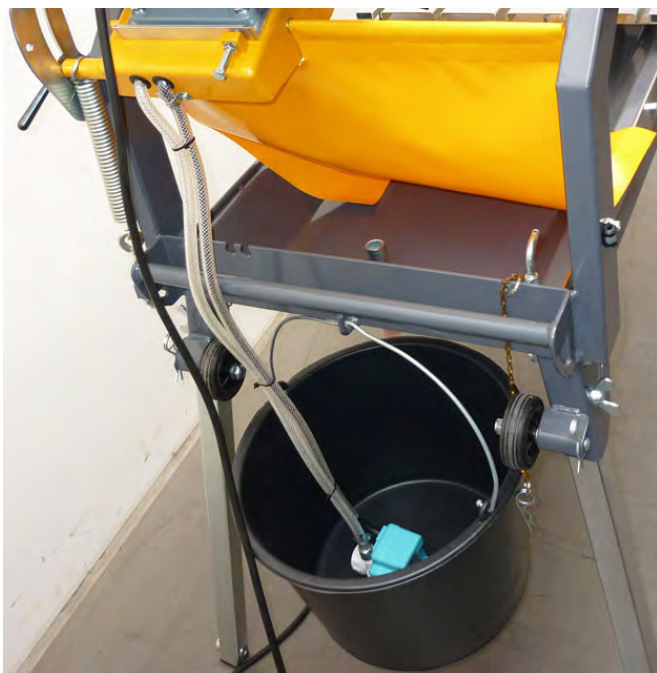
Переливная пробка в сливной отверстии в ванне, водяной насос в ведре под рамой настольной пилы
