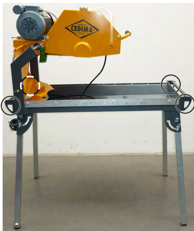
Крановые проушины на рукоятках настольной пилы, роликовый стол и диск сняты
