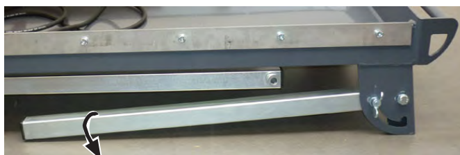
Выворачивание опорных ножек
