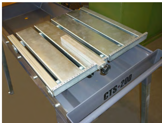
Боковой упор закреплен на упоре роликового стола Рис. 4.19
