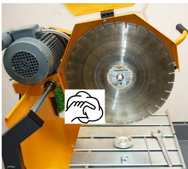
Установите алмазный диск на режущий вал
