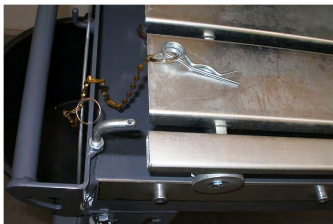
Снятие транспортного фиксатора роликового стола
